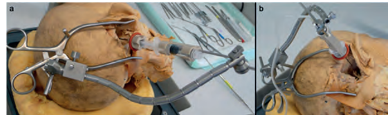
Abb. 2: Evaluation des Cochlear-Hydro-Drives an einem anatomischen Präparat. MHH-interne regulatorische Prozesse wurden angestoßen, um eine künftige In-House-Fertigung (in der MHH) im Einklang mit der Medizinprodukterichtlinie der EU zu ermöglichen. Der erste klinische Einsatz ist in 2022 geplant.
