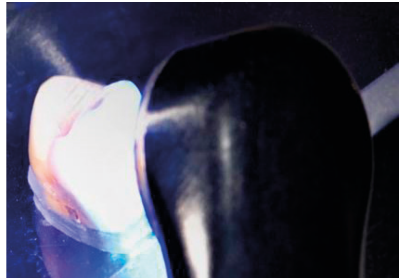
Abb. 3: Temperaturmessung an einem Prämolaren im Versuchsaufbau „Lichtexposition ohne Schutzhülle“
