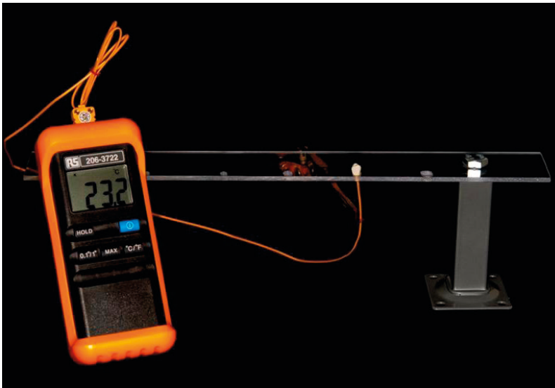
Abb. 2: Versuchsaufbau: Digital-Thermometer, Zahn mit Mess-Sonde, Halterung für Zahn aus Plexiglas
