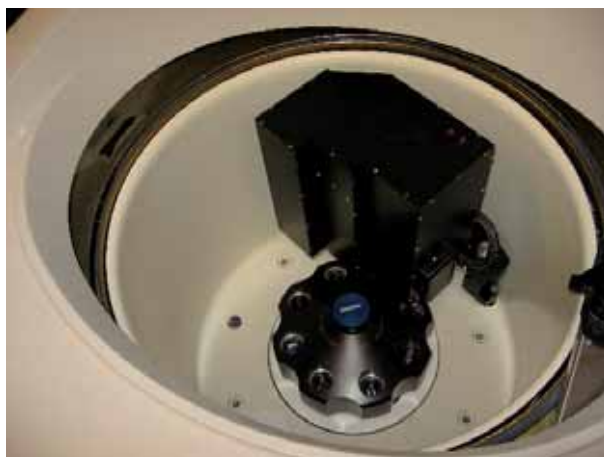
Abb. 2: Probenraum der analytischen Ultrazentrifuge mit Rotor und Fluoreszenzdetektionseinheit
