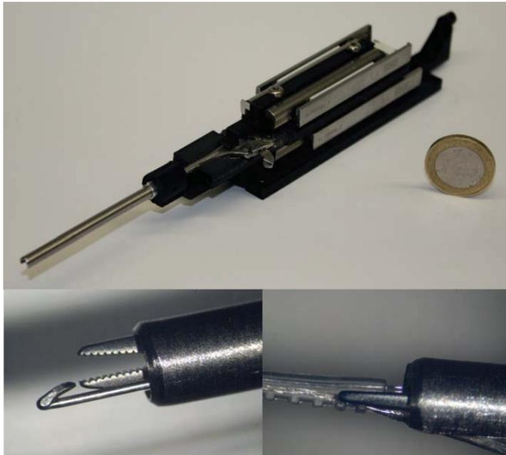
**Abb.1:** Mechatronisches Insertionstool für die hochgenaue, computergesteuerte Insertion von CI-Elektroden.
