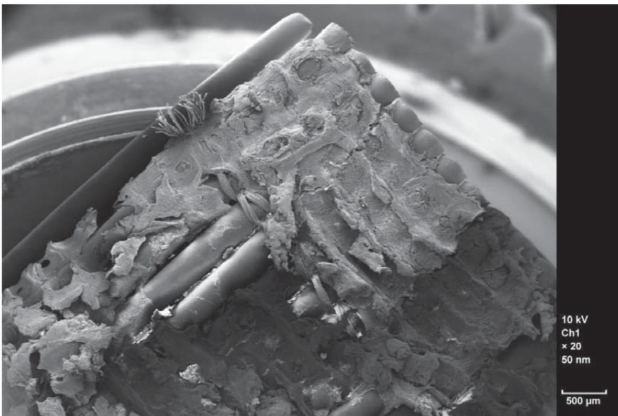
**Abb. 2:** Elektronenmikroskopische Aufnahme einer verstopften Membran
