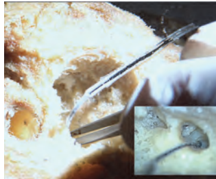
Abb. 5: Insertionstest eines selbstbiegenden CNT-Implantatmusters in ein Felsenbein.
