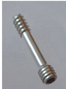
Abb. 1: Bild der bioresorbierbaren Frakturkompressionsschraube aus der Magnesiumbasislegierung MgYREZr der Firma Syntellix AG, Hannover. Zur Prüfung der biologischen Unbedenklichkeit des neuen Implantatwerkstoffes wurde das selbstschneidende Kopfgewinde der Schraubenspitze in den Kaninchenfemur eingebracht.
