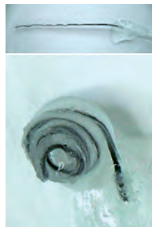
Abb. 2: CI-Schaft mit CNT-Elektrode vor (oben) und 24h nach Einlegen in Perilymphe (unten)
