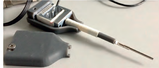
Abb. 1: Prototyp des intraoperativen Kraftsensors
