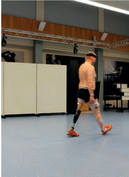
Abb. 1: Proband mit einer osseointegrierten Prothesenverankerung beim Gehen in der Ebene im Ganglabor OrthoGO
