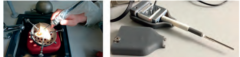
Abb. 1: Prototyp des intraoperativen Kraftsensors
