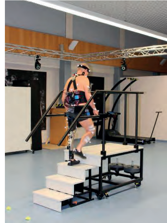
Abb. 2: Proband mit einer Schaftversorgung beim Treppensteigen im Ganglabor OrthoGO.
