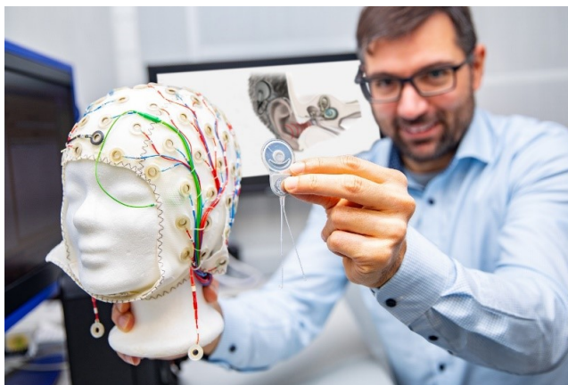
Mit einer EEG-Haube misst Professor Dr. Waldo Nogueira Vazquez die akustischen und elektrischen Signale bei der Hörverarbeitung im Gehirn Copyright: Karin Kaiser / MHH
