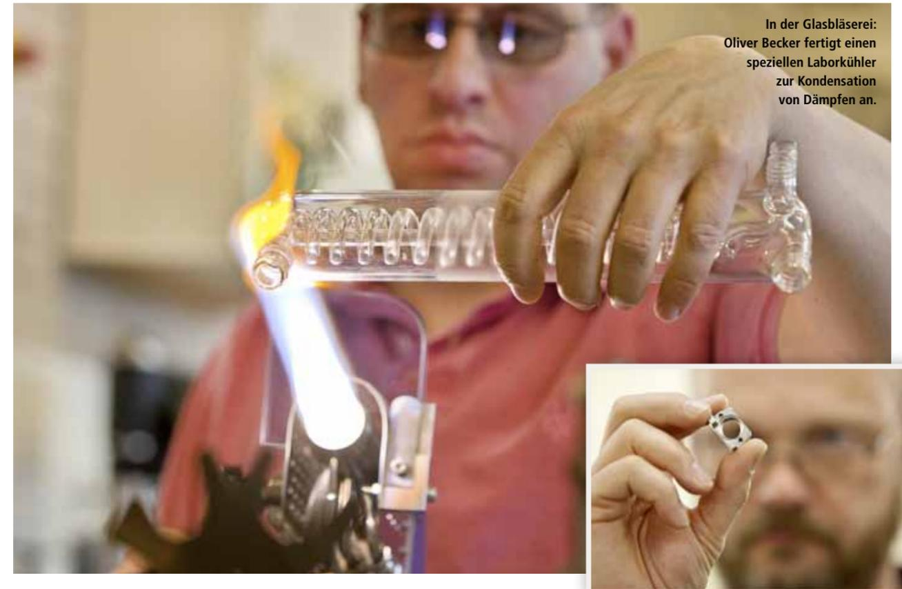
In der Glasbläserei: Oliver Becker fertigt einen speziellen Laborkühler zur Kondensation von Dämpfen an.
