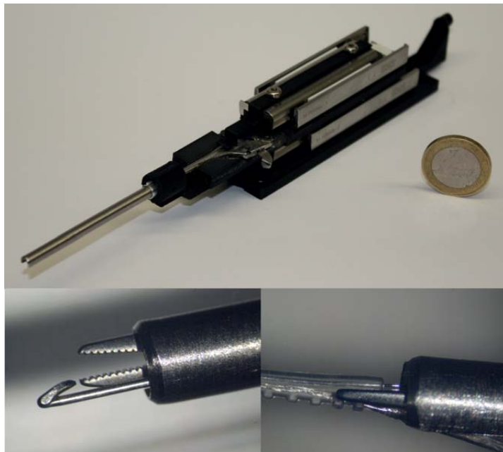
Abb.1: Mechatrisches Insertionstool für die hochgenaue, computergesteuerte Insertion von CI-Elektroden.
