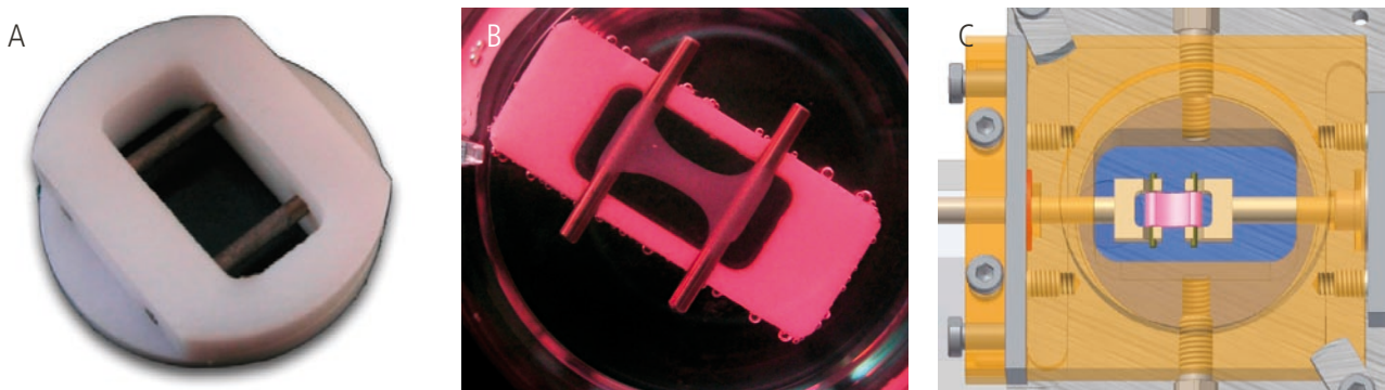
Abb. 1: Darstellung der verschiedenen Stadien zur Herstellung von bioartifiziellem, kardialem 3D Gewebe. A: Teflonwanne, in die das flüssige Zell/Matrixgemisch in einem Volumen von 220 \mu l eingebracht wird. Die zwei Titanstäbchen dienen der Matrix als Fixierungspunkte. Des Weiteren erlaubt diese Wanne durch ihren fehlenden Boden die Reifung des Gewebes mikroskopisch zu observieren. B: Spontan kontrahierendes, sieben Tage altes Gewebe mit Rattenherzmuskelzellen. C: Kulturgefäß, in dem das künstliche Gewebe nach Konsolidierung chemisch, elektrisch und mechanisch stimuliert wird und das darüber hinaus kontinuierliche Kraftmessungen unter sterilen Bedingungen erlaubt.
