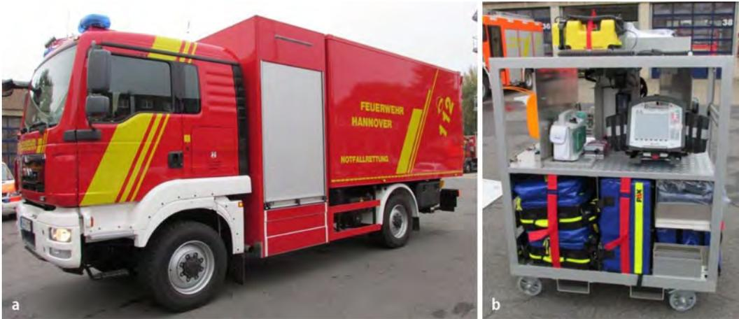
**Abb. 3** ◀ Gerätewagen Rettungsdienst (GW-Rett) der Berufsfeuerwehr Hannover. **a** Das allradgetriebene Fahrzeug verfügt über eine Ladebordwand. **b** Das Material steht in Rollwagen bereit
